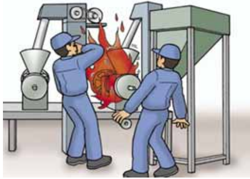
在进行铝镁合金粉碎加工作业的过程中发生粉尘爆炸，致使2名作业人员死亡。
