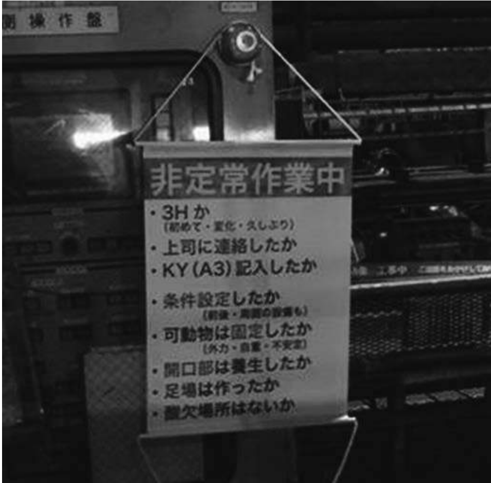
資料 13 非常作業実施中表示例
