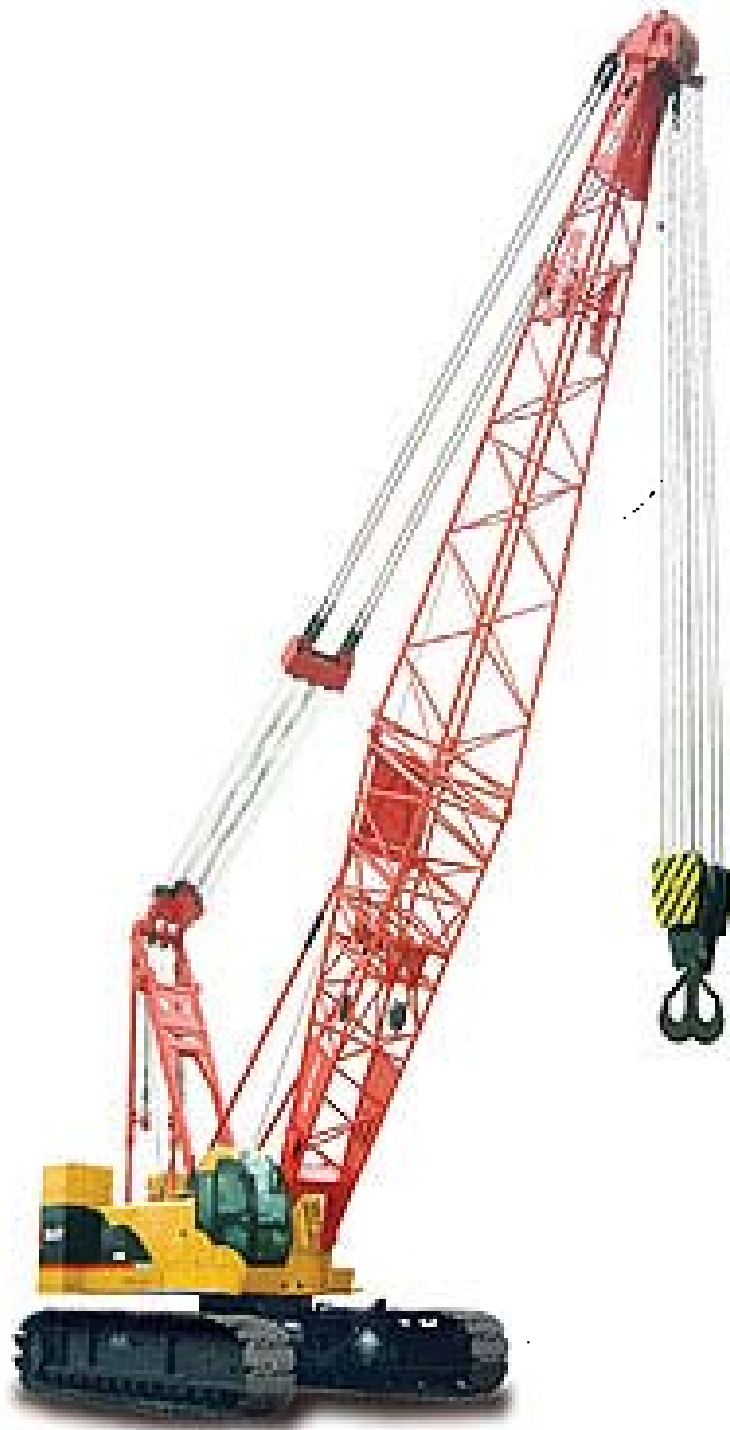
1. 副臂架 2. 主臂架(塔身) 3. 履带 日立公司 KH1000 型塔式履带起重机
