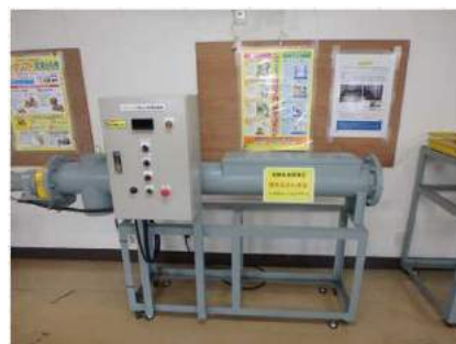
図 203 ロール機による、「はさまれ、巻き込まれ」危険体感教育設備（左）、スクリーンコンベアでの、「はさまれ、巻き込まれ」危険体感教育設備（右）
