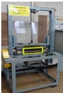
図 203 ロール機による、「はさまれ、巻き込まれ」危険体感教育設備（左）、スクリーンコンベアでの、「はさまれ、巻き込まれ」危険体感教育設備（右）
