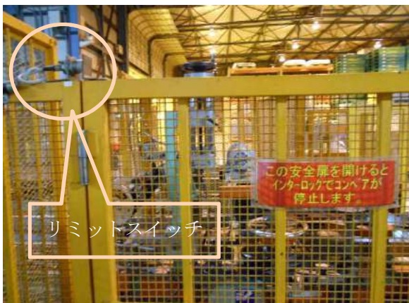
図 188 安全柵の扉にリミットスイッチを設置した事例
