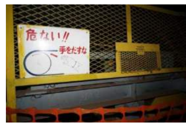
図 187 ベルトコンベアに安全カバーを設置した事例
