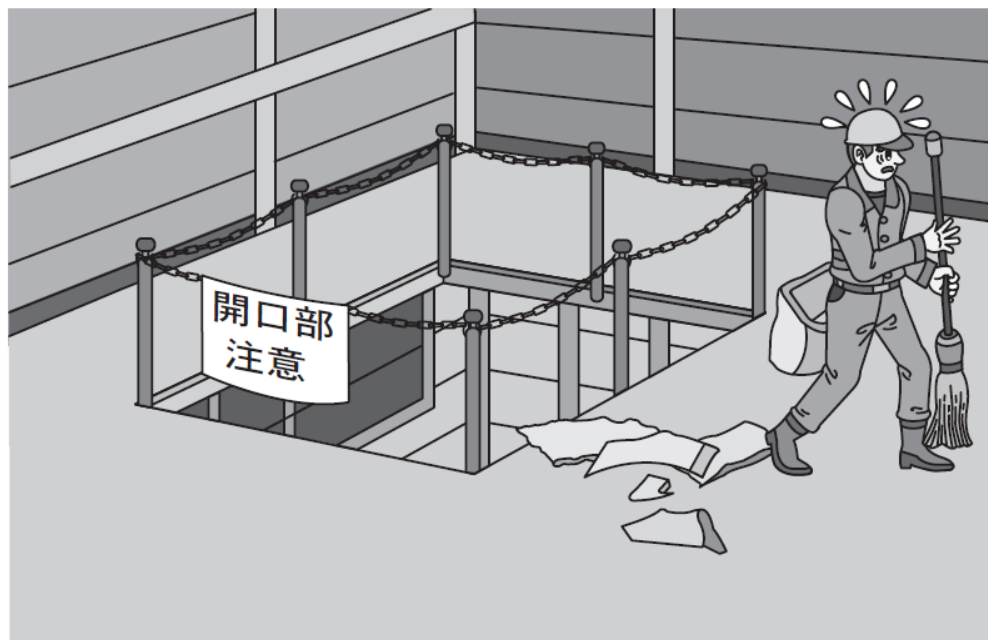
開口部付近の清掃作業の例
