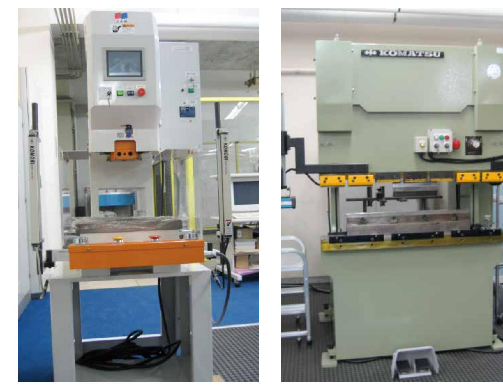
研修用のサーボプレス(左)と液圧プレスブレーキ(右)
