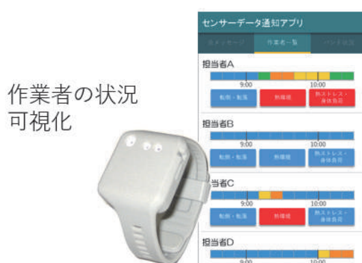
図 4-6 導入している対策の一つのバイタルセンシングバンドを用いた作業員の状況管理によるパフォーマンスの調整・維持（ダイキン工業株式会社） 19
