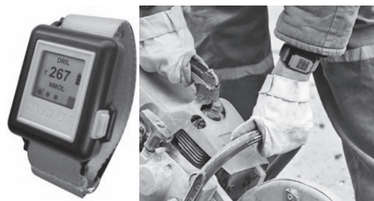
図1 英国で手腕振動リスク管理に用いられている装置と実際の装着例
