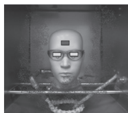
図1 人頭を用いた防じん試験および改良前後での防じん率の変化
