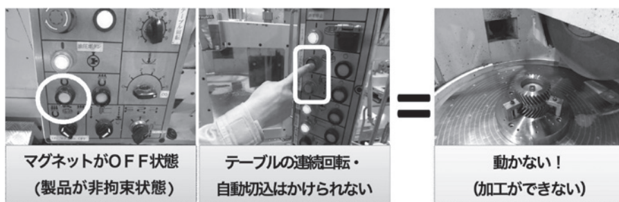
写真3 対策後の起動条件
